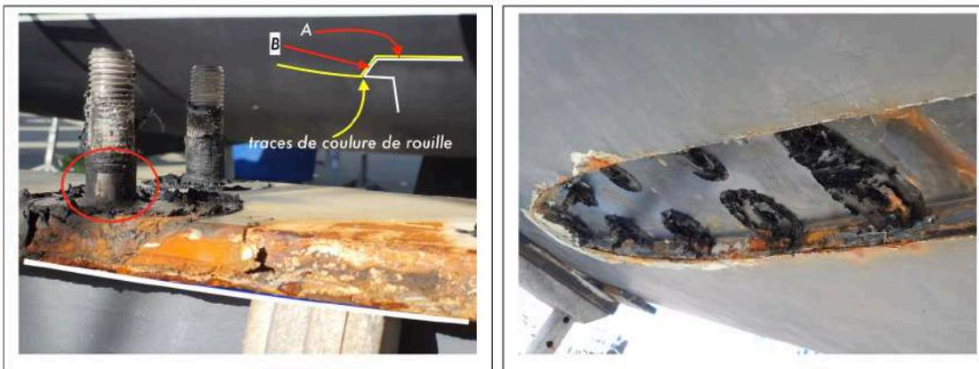
*Il est mécaniquement impossible d'avoir un contact surface contre surface simultanément en A et B car la géométrie est surabondante. On privilégie l'appui sur A car c'est la surface fonctionnelle, la surface B est liée à la hauteur d'implantation du goujon ou de la tête de la vis, suivant le type d'assemblage. Son encastrement dans l'épaisseur de la coque est optionnel, la semelle pourrait très bien être entièrement en surépaisseur sur la coque du bateau.*
